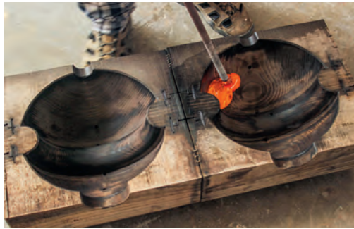
Vor der Erstbenutzung wird die hölzerne Negativform mit heissem Glas ausgebrannt.
