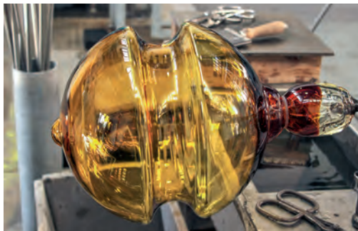
Der eingeblasene Glaskörper vor dem Abkühlen.
